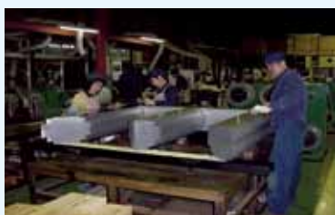
コア組工程 (Core Assembling Process)
